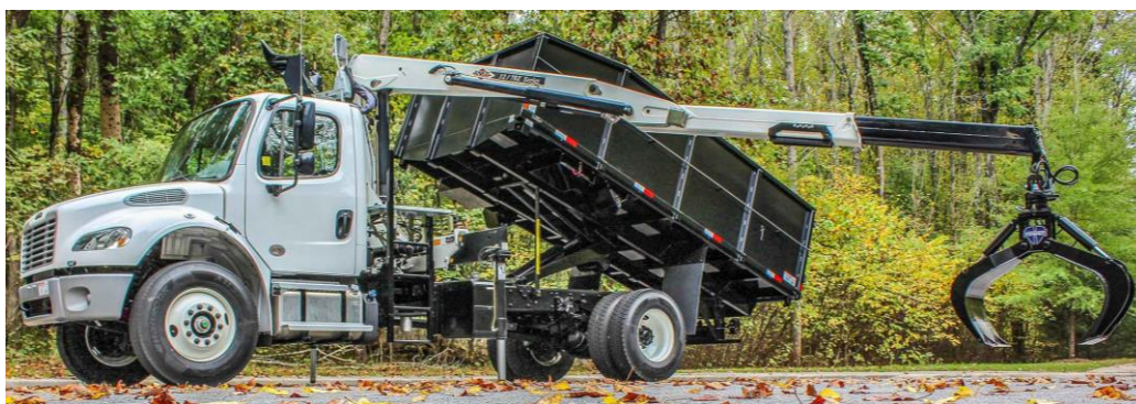
Figura 21: autocarro con cassone ribaltabile, braccio idraulico e testa di presa. ( https://www.customtruck.com/ )
